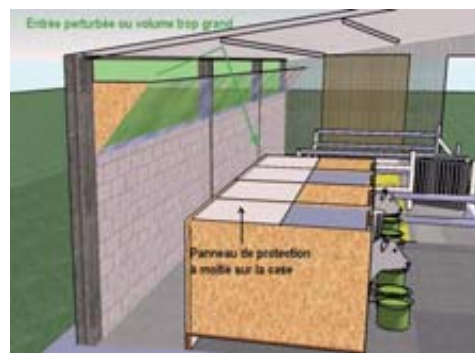
Figures 3a, 3b et 3c. Solutions pour éviter les retombées et réduire le volume d'air
